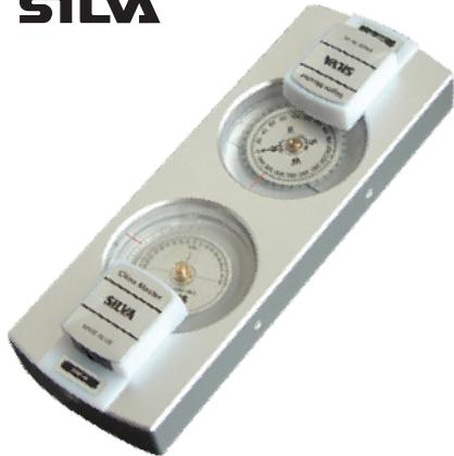
Clino-bussola, che comprende una bussola ed un clinometro di precisione con lettura attraverso prisma.
