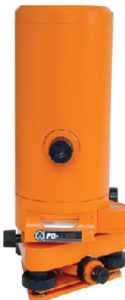
Piombo ottico zenithale di elevata precisione completamente autolivellante.
