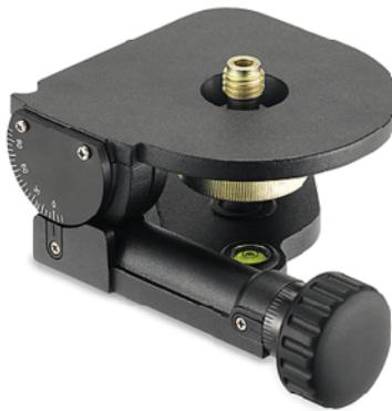
Questo piccolo e pratico accessorio è necessario per realizzare pendenze comprese tra 0° e 90° con tutti i livelli laser che possono operare in modalità "manuale", quindi col compensatore ed allarme di fuori bolla disattivati.
