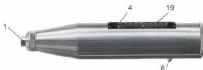
Fig. 2.4 Lettura dei risultati del test sulla scala (19) dei modelli N e L
