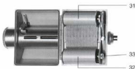
Fig. 3.2 Inserimento di un nuovo rotolo di carta per la registrazione
