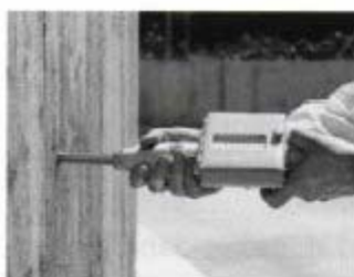
Fig. 2.3 Esecuzione del test (la figura illustra il modello NR)
