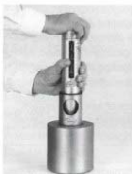
Fig. 3.1 Controllo funzionale dello sclerometro (la figura illustra il modello N/L)
